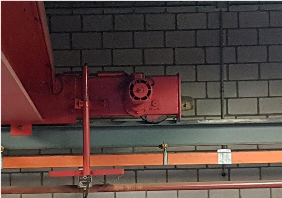
Stirnradgetriebemotor BG 90, 0.75kW,
