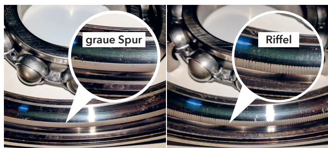
Abbildung 1: Die beiden typischen Schadensbilder durch Lagerströme; links: graue Spur, rechts: Riffelbildung.
