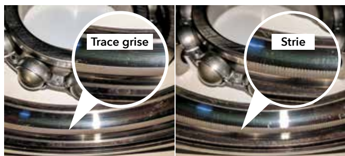
Illustration 1: Les deux dommages caractéristiques des courants de palier; à gauche: trace grise, à droite: formation de stries.
