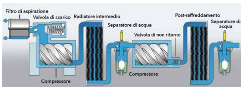
Figura 8: Compressore a vite a secco (fonte: Atlas Copco)
