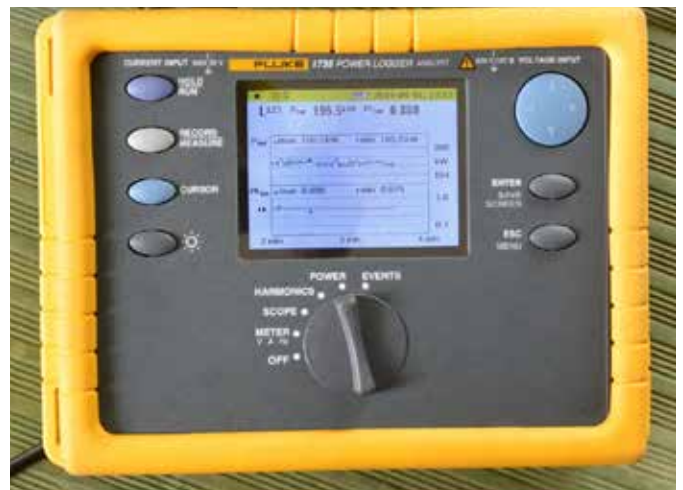
Oben: 3-phasiges Messgerät mit Stromzangen und Loggerfunktion.
