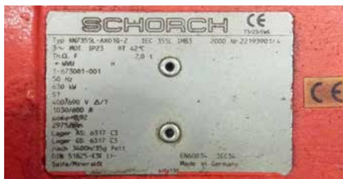
Moteur d'entraînement du compresseur: Schorch, année de construction 2000, 630 kW, 2 pôles, 2975 tours par minute, service continu S1, cos φ 0,92
