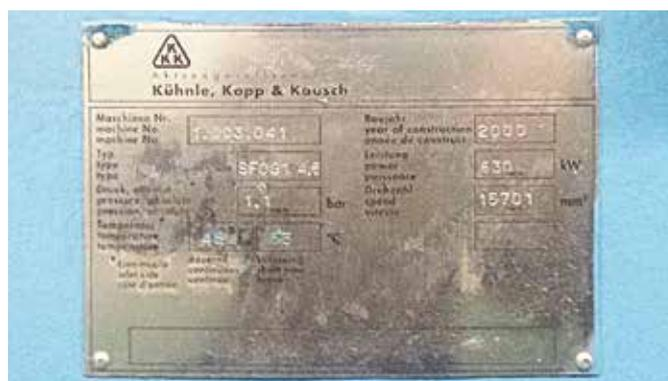
Turbocompresseur pour l'air comprimé: Kühnle, Kopp & Kausch, année de construction 2000, 630 kW, 1,1 bar, 15 701 tours par min.
