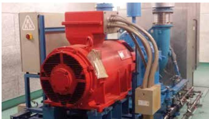
Moteur et turbocompresseur sur le même arbre
