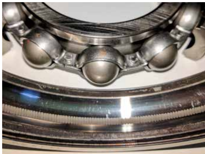
Foto: Riffelbildung durch Lagerströme (Quelle: Dr. Hanna Putzi-Plesko, ZHAW School of Engineering)
